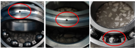
(b) 轴承内圈故障 (c) 轴承外圈故障 (d) 轴承滚动体故障
